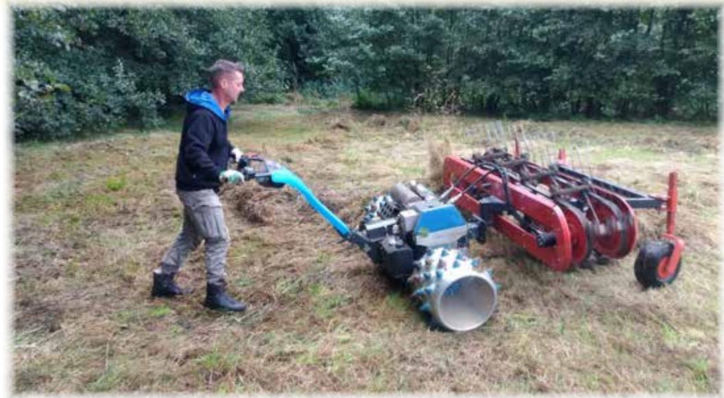
*Durch das Schwaden wird das Mahdgut auf Streifen gelegt und muss zwar von Hand von der Fläche geholt, aber wenigstens nicht per Hand zusammengereicht werden.*
